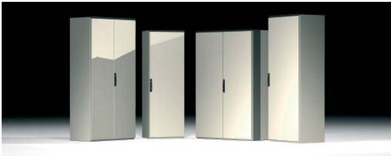
Una estructura en una unidad soldada con panel posterior removible es la base del armario de la gama ATB8, disponible en dos profundidades (400-500mm) y altos de 1000mm a 2000mm. La puerta, con 3 o 4 bisagras (dependiendo de la altura), es extremadamente rígida gracias al bastidor montado en el interior de la puerta. La placa de montaje doblemente doblada en las aristas está realizada en acero de 2,5 mm y es regulable en profundidad. La placa de entrada de cables es también ajustable.
